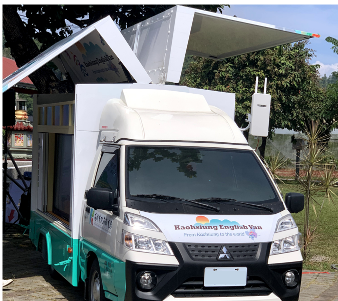
圖一：使用 4G LTE 模組的 OAP100，安裝於車前左側，其安裝支架可根據連線需求調整角度。
